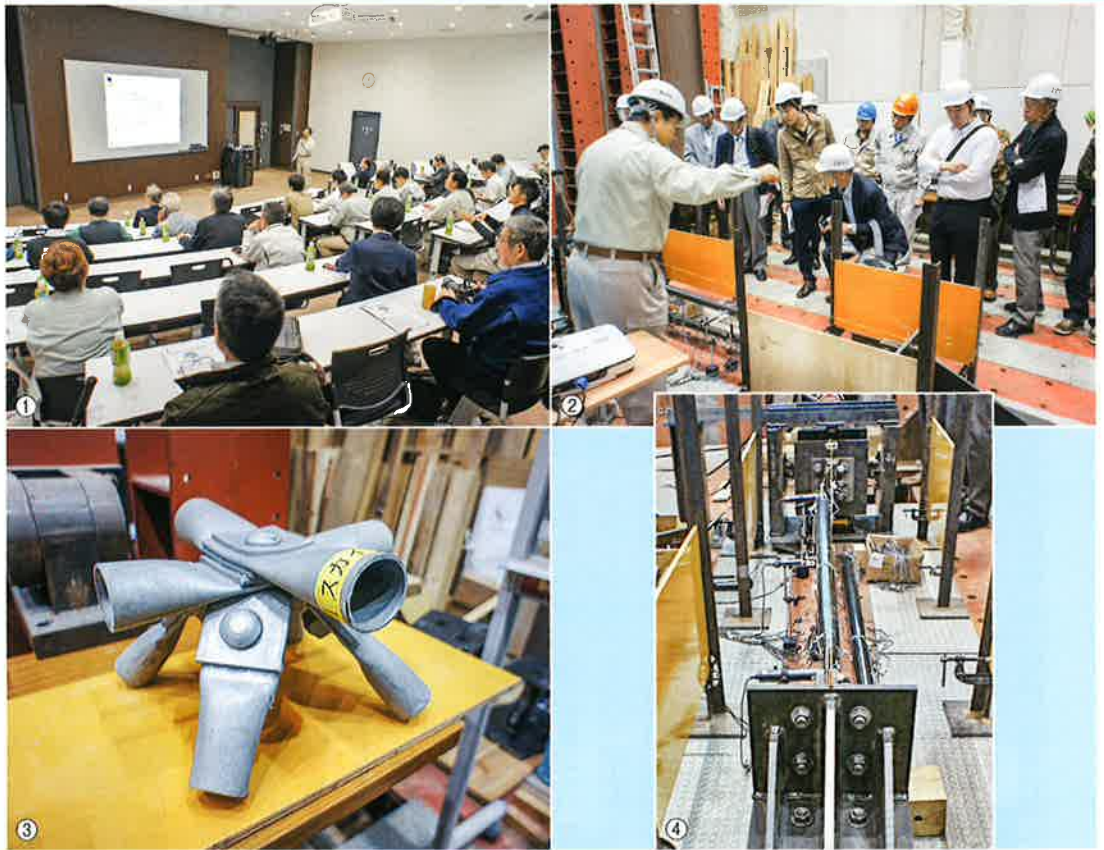
①中西教授が実験概要を説明②座屈の状態を観察する参加者③「SKYトラス」の端部見本④奥側の端部が変形
