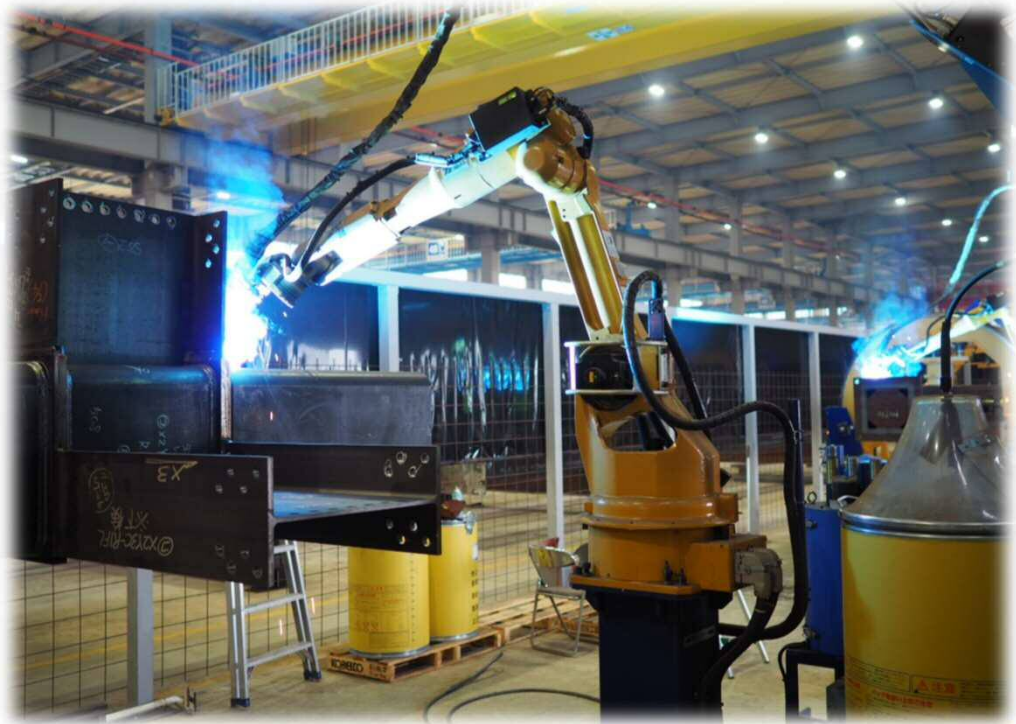
溶接ロボット
